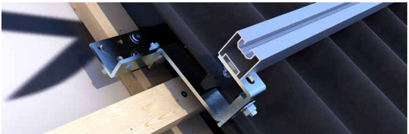
Dachhaken FLEX an der Konterlatte montiert, durch die ausgeklinkte Dachpfanne geführt und mit montiertem Montageprofil Steildach.
